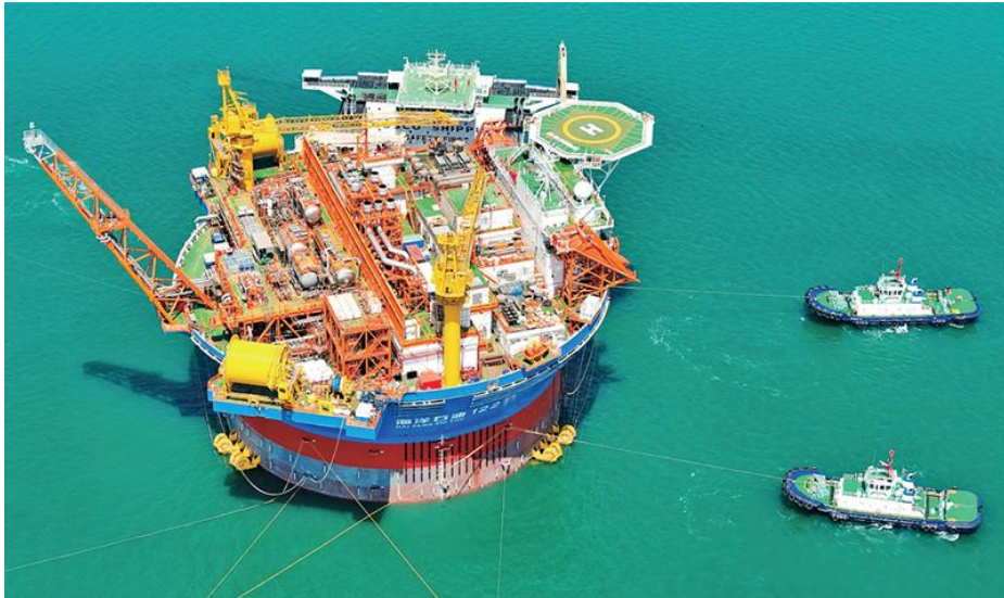
“海葵一号”，是亚洲首艘圆筒型浮式生产储卸油装置。该装置集原油生产、存储、外输等功能于一体，被网友们昵称为“超级能源碗”，也是完全由我国自主设计建造的海上油气加工厂。图为2024年5月12日，“海葵一号”从中国海油青岛国际化高端装备制造基地离港启运。
